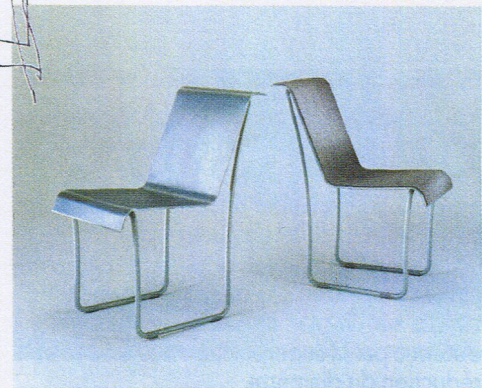
Frank Gehry dans son agence, devant des prototypes. La Superlight (2,92 kg), légère et flexible, est une feuille d'aluminium pliée et ourlée sur son pourtour, désolidarisée de la structure tubulaire par des clips en PVC.
